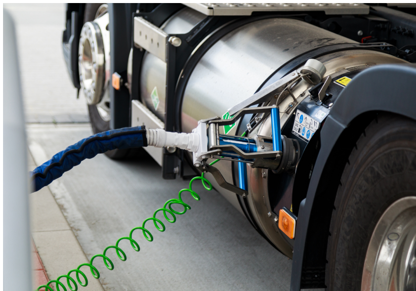
Uziemiony zbiornik samochodu ciężarowego podczas tankowania
