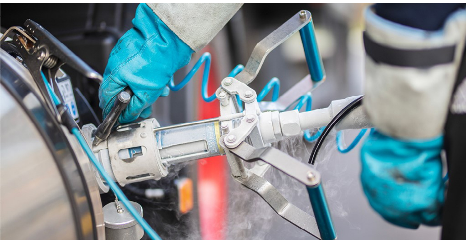
Tankowanie zbiornika LNG
